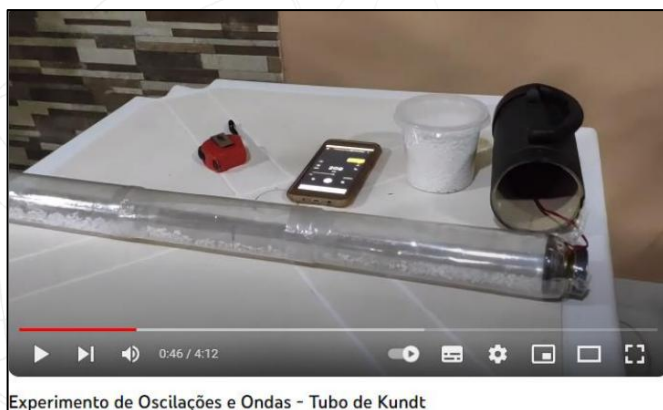
Figura 9 – Demonstração das ondas sonoras através do Tubo de Kundt
