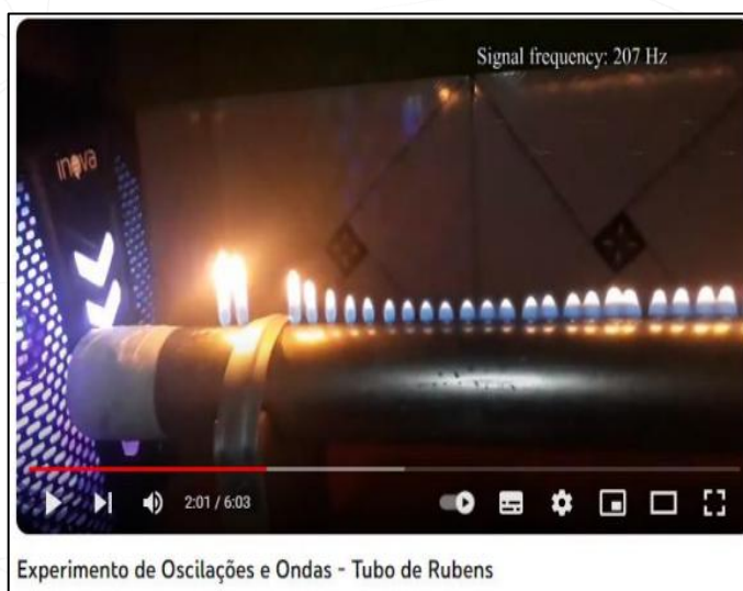
Figura 10 – Demonstração das ondas sonoras através do tubo de Rubens
